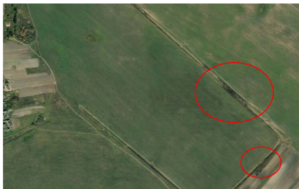
Рис. 1. Пример зарастания открытых каналов кустарником
