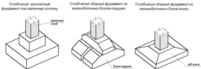
Рис. 4.6. Варианты устройства столбчатого фундамента
