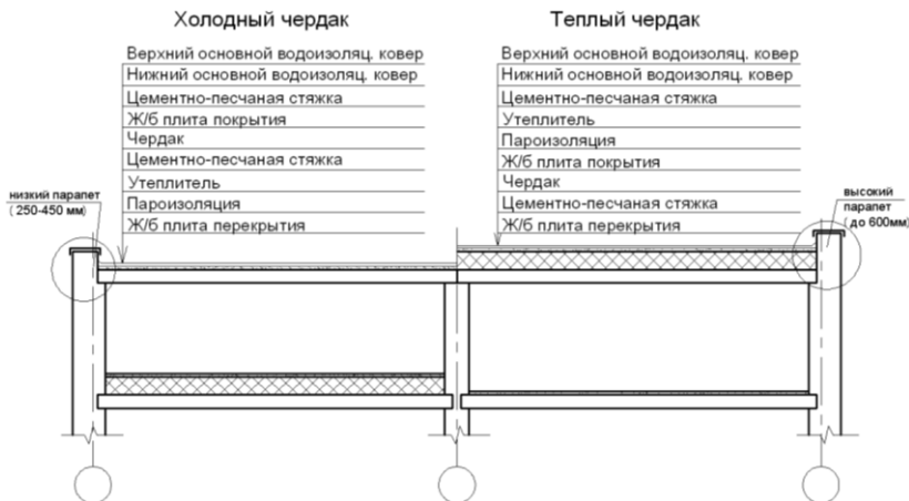
Рис. 9.4. Конструкция раздельной кровли
