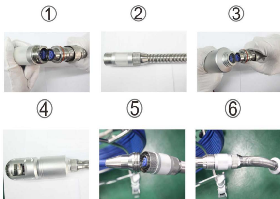
Рис. 22.5. Последовательность подключения видеокамеры
