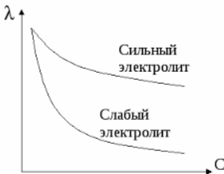
Рис. 7.2. Зависимость удельной электропроводности от силы электролита
