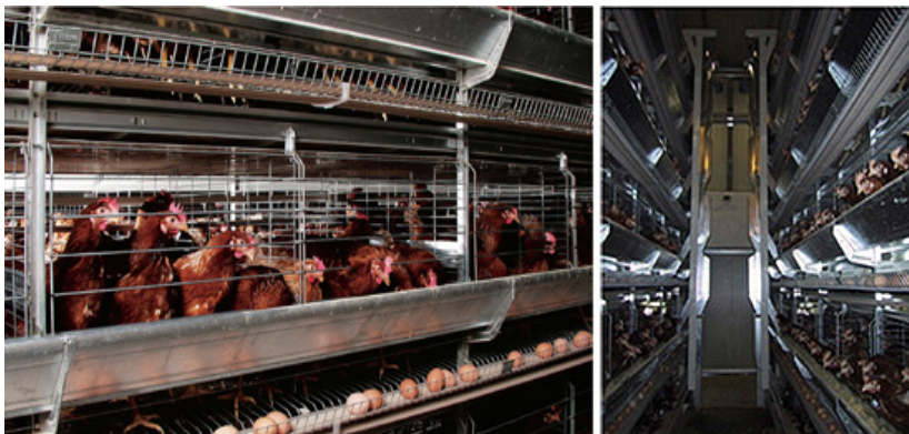
Рис. 43. Клеточная батарея для кур-несушек
