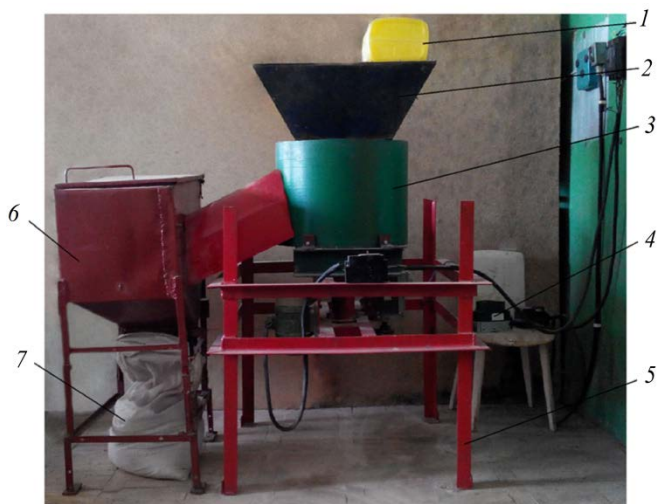
Рис. 3.11. Общий вид экспериментальной установки: 1 – резервуар жидких компонентов; 2 – бункер-дозатор сухих компонентов с раздельной камерой для семян; 3 – камера смешивания дражжирователя; 4 – частотный преобразователь; 5 – рама; 6 – выгрузный бункер; 7 – мешок с обработанными семенами
