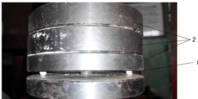
Рис. 3.10. Общий вид установки для определения прочности оболочки: 1 – семя; 2 – металлические пластины
