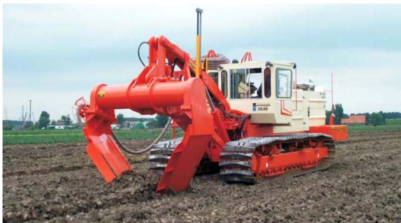
Рис. 2.31. Дреноукладчик с Δ-плугом
