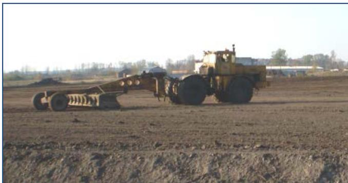
Рис. 5.71. Полуприцепной длиннобазовый планировщик в работе
