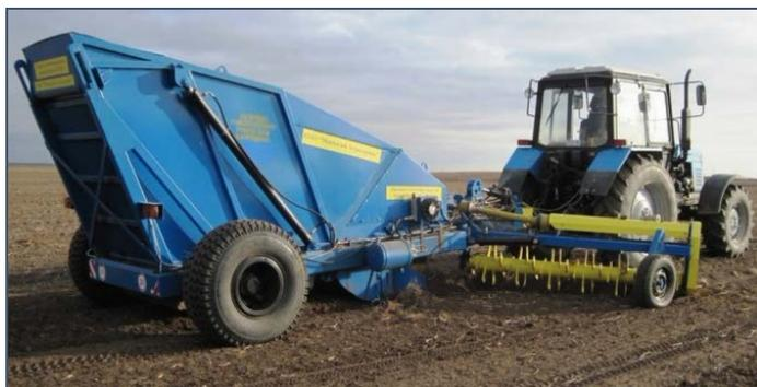
Рис. 5.59. Машина камнеуборочная комбинированная КKM-1
