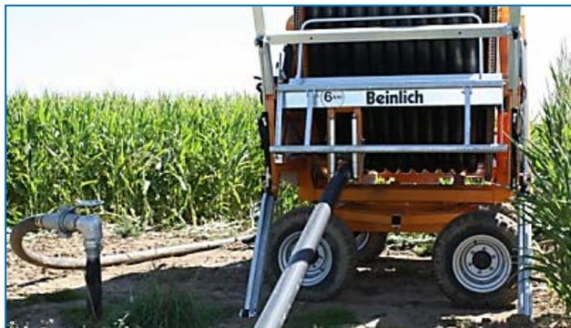
Рис. 6.17. Установка с поворотным барабаном
