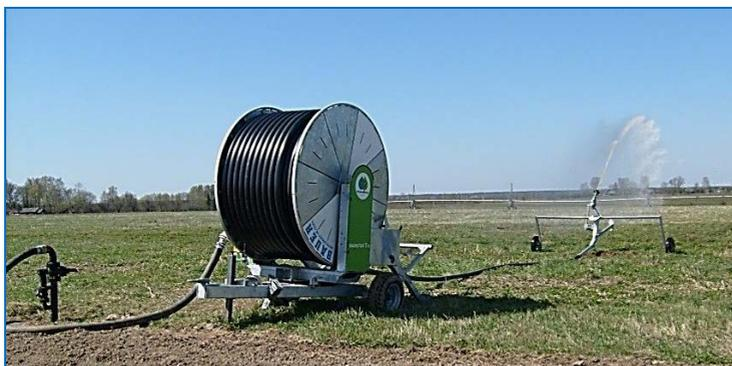
Рис. 6.18. Шланговый дождеватель в работе
