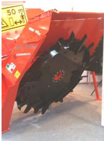
Рис. 4.8. Вид рабочего органа каналокопателя фирмы Cosmeco
