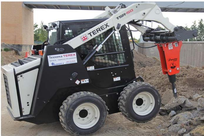
Рис. 5.41. Мини-погрузчик с гидромолотом IMPULSE 120
