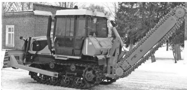
Рис. 2.43. Экскаватор-траншеекопатель МЗЦ-75
