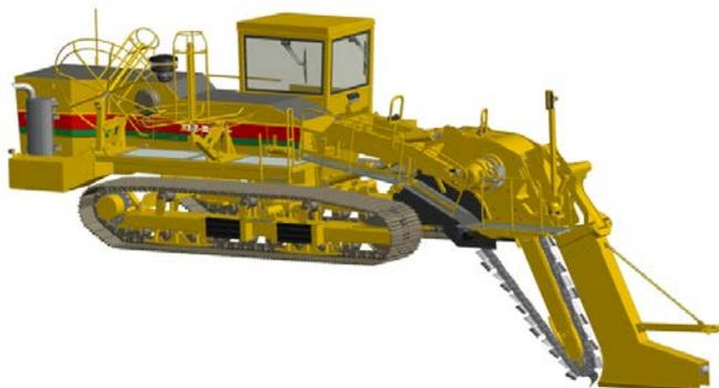
Рис. 2.55. Перспективный цепной скребковый экскаватор-дреноукладчик
