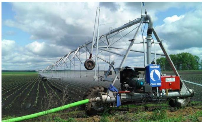
Рис. 6.37. Вид широкозахватной дождевальной машины фирмы Rainke
