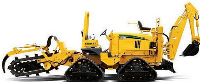
Рис. 2.50. Скробковый цепной экскаватор-траншекопатель VERMEER RTX1250
