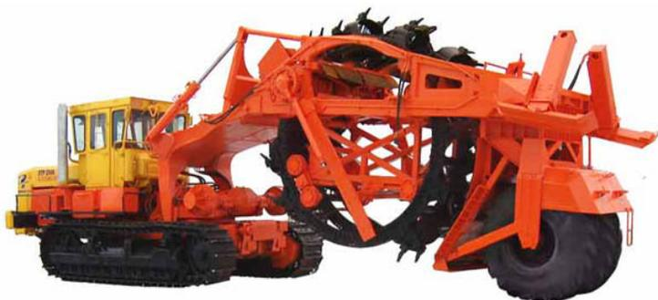
Рис. 2.40. Многоковшовый роторный экскаватор-траншеекопатель ЭТР-254
