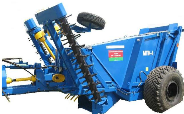
Рис. 5.56. Валкователь-подборщик МПК-4 производства ОАО «Витебский мотороремонтный завод»
