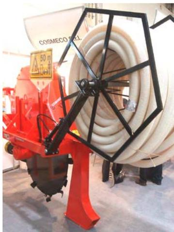
Рис. 2.58. Дисковый скребковый рабочий орган экскаватора-дренукладчика фирмы Cosmesco
