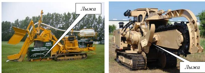
Рис. 2.56. Цепные скребковые экскаваторы-дреноукладчики с опорными устройствами рабочего органа
