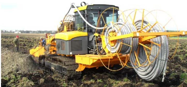
Рис. 2.35. Экскаватор-дреноукладчик ЭТЦ-203 в работе
