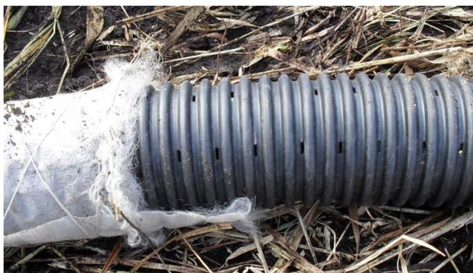
Рис. 2.8. Гофрированная пластмассовая труба с фильтрующим защитным материалом
