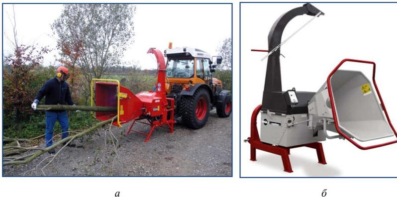
Рис. 5.7. Машина WOODCHIPPER H 160 в работе (*а*) и рабочее оборудование без трактора (*б*)
