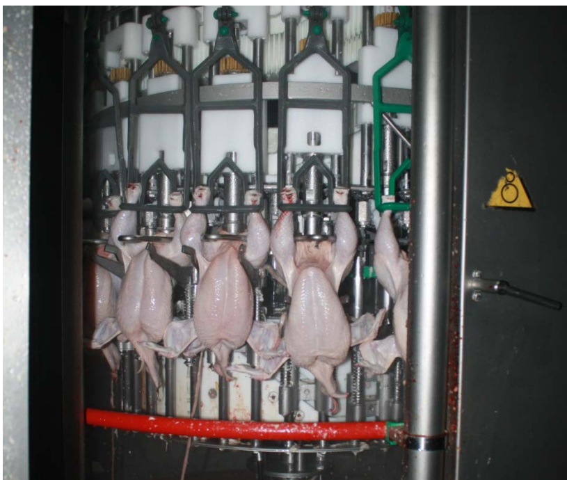
Рис. 26. Автоматическое удаление легких и почек
