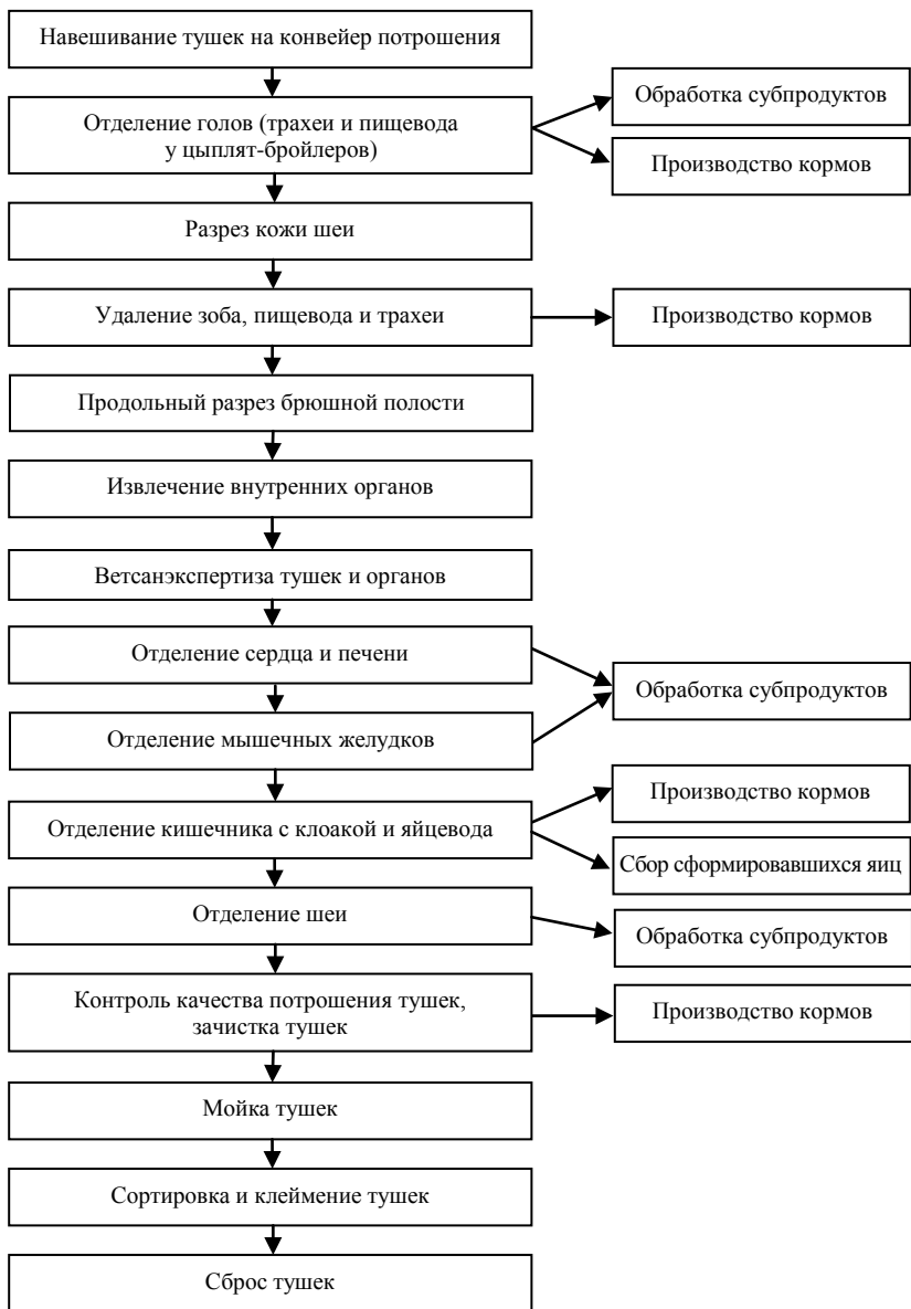
Рис. 17. Технологическая схема потрошения тушек
