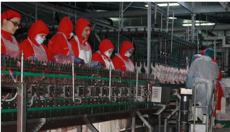
Рис. 21. Автоматическая линия по разделению внутренних органов
