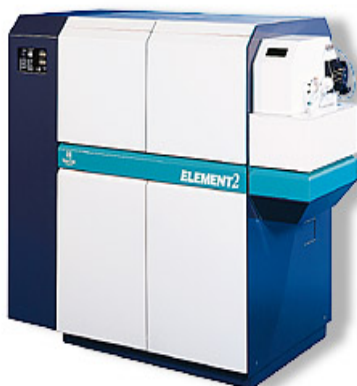
Рис. 8.5. Масс-спектрометр с индуктивно связанной плазмой (Thermo Finnigan MAT)
