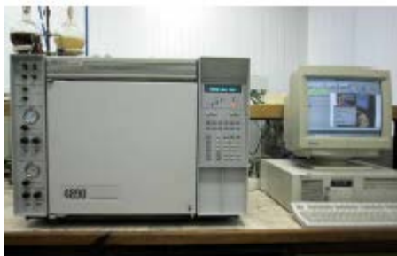
Рис. 14.5. Газовый хроматограф HP 4890D Hewlett Packard (США)
