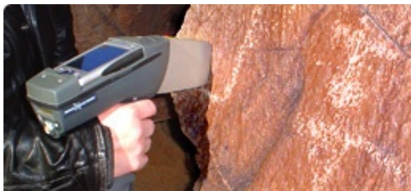
Рис. 8.6. Портативный рентгено-флуоресцентный анализатор (Innov-X Systems)
