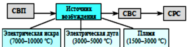
Рис. 9.1. Общая схема спектральных приборов
