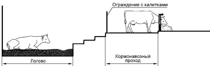
Рис. 3.18. Технологический модуль для беспривязного содержания скота в секциях с заглубленным логовом и несменяемой подстилкой
