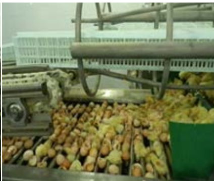
Рис. 2.15. Роликовый механизм сортировки
