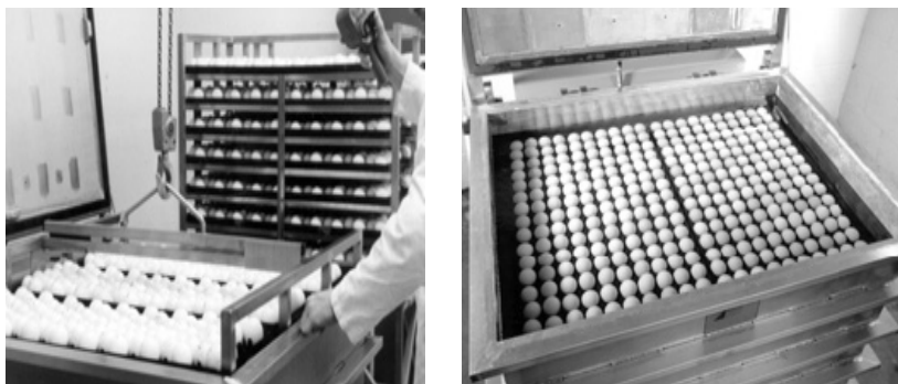
Рис. 4.1. Обработка инкубационных яиц методом прямого перепада давления
