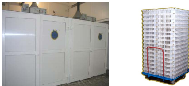
Рис. 1.22. Инкубатор выводной ИВ-18 «Машук» (слева) и тележка с лотками (справа)
