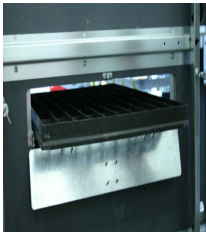
Рис. 2.22. Система транспортировки инкубационных лотков
