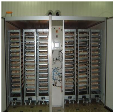
Рис. 1.28. Инкубационный (слева) и выводной (справа) шкафы ЕМКА-ПСМ серии VH
