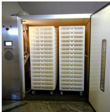
Рис. 1.28. Инкубационный (слева) и выводной (справа) шкафы ЕМКА-ПСМ серии VH
