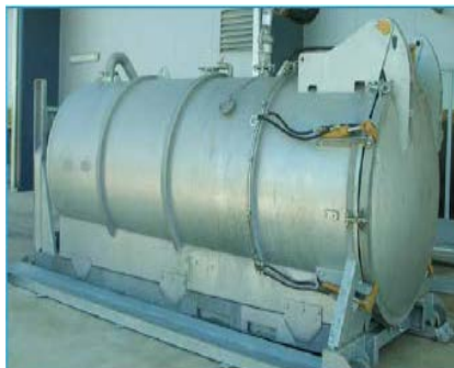
Рис. 1.51. Вакуумная система утилизации отходов компании «Viscon»
