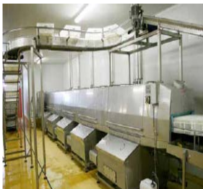
Рис. 1.52. Моечная установка компании «Viscon» для выводных корзин
