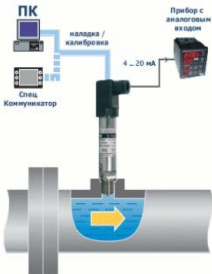
Рис. 4.4. Место установки датчиков давления на трубопроводе
