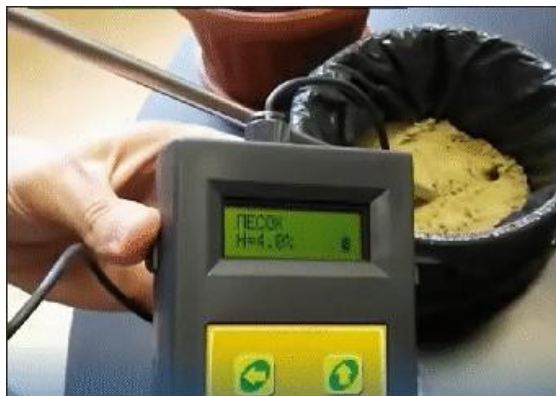
Рис. 7.12. Влажность песка, измеренная прибором МГ-44
