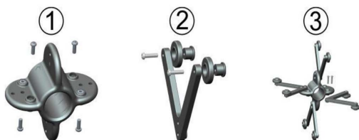
Рис. 11.6. Последовательность сборки и установки направляющих
