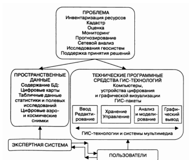
Рис. 9.1. Структурная схема и базовые составляющие проблемно ориентированной ГИС
