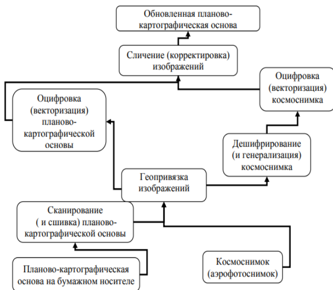
Рис. 4.3. Этапы обновления планово-картографического материала по данным дистанционного зондирования Земли
