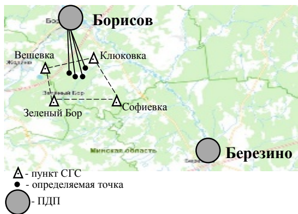
Рис. 3.13. Расположение пунктов СГС-1 на территории объекта работ
