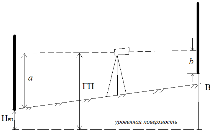
Рис. 6.10. Вынос на местность проектной точки по высоте
