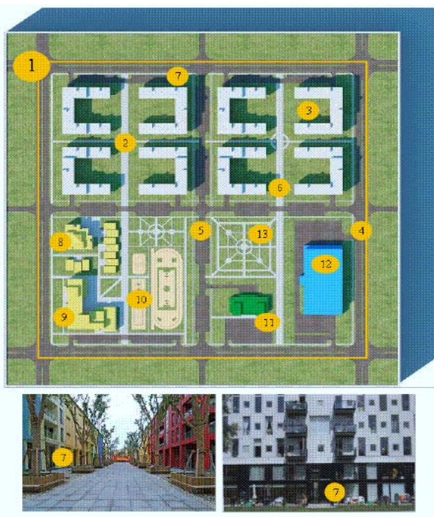
Рис. 1. Схема многофункционального модуля жилого района с приоритетной производственной функцией: 1 – модуль; 2 – соседство; 3 – двор; 4 – магистральная улица районного значения; 5 – жилая улица; 6 – пешеходная улица; 7 – встроенные общественные объекты; 8 – детский сад; 9 – школа; 10 – спортивно-оздоровительная зона; 11 – торгово-общественный центр; 12 – производственный объект; 13 – общественное пространство
