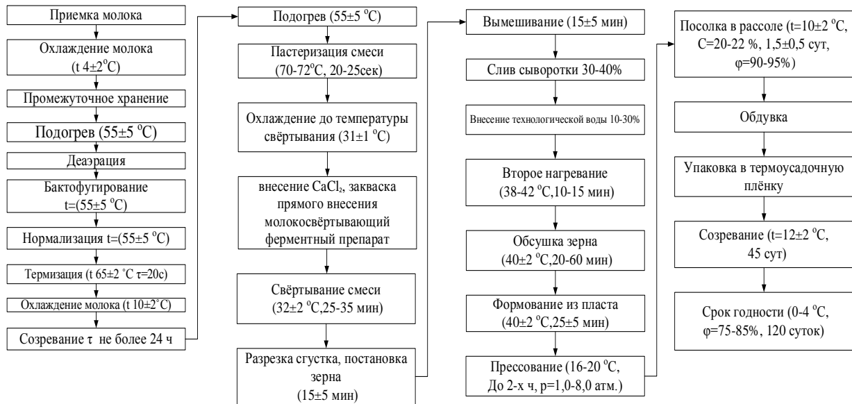
Рис. 1. Технологическая схема производства сыра
