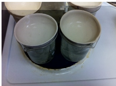
Рис. 8.41. Выпаривание на водяной бане
