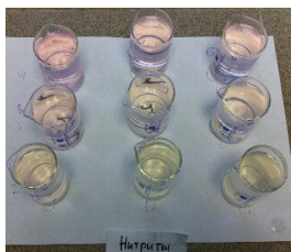
Рис. 8.33. Пробы воды сразу после добавления 2 см 3 раствора реактива Грисса (начали изменять окраску)
