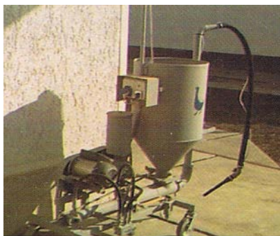
Рис. 36. Машина для принудительного откорма птицы
