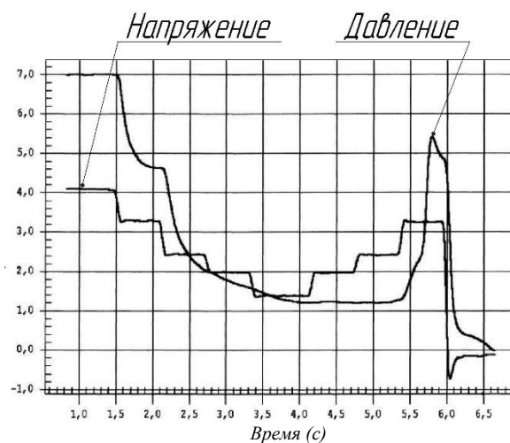
Рис. 3. Графики зависимости напряжения управления и давления во фрикционной муфте от времени
