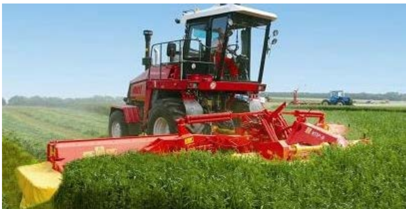
Рис. 1.17. Косилка-плющилка навесная фронтальная КПН-6-Ф «ПАЛЕССЕ СН60F»
