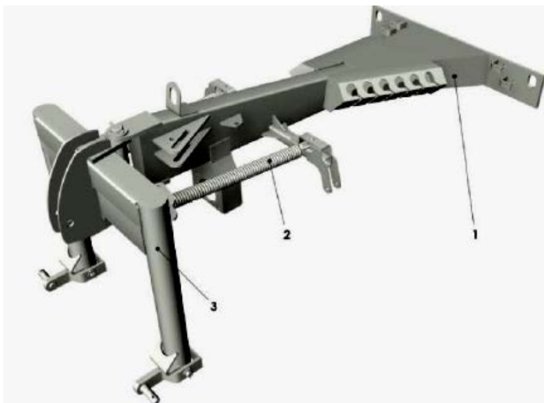
Рис. 2.11. Рама с навеской и пружинами: 1 – рама; 2 – пружина; 3 – навеска
