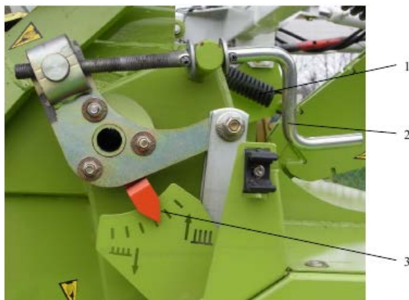
Рис. 1.7. Настройка высоты среза: 1 – пружина; 2 – ручка; 3 – шкала высоты среза
