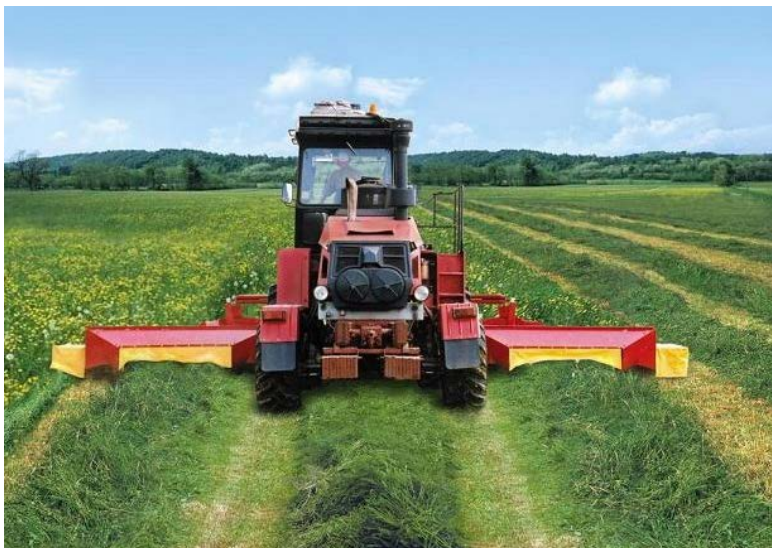
Рис. 1.16. Косилка-плющилка трехсекционная ротационная навесная КПР-9 «ПАЛЕССЕ СН90»
