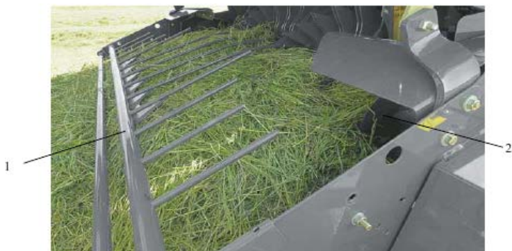
Рис. 3.2. Барабанный подборщик: 1 – прижимное устройство; 2 – винтовой конвейер
