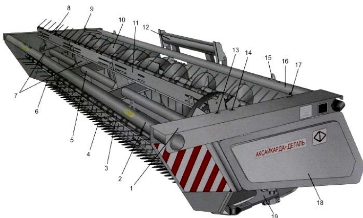
Рис. 4.10. Жатка травяная: 1 – левая боковина жатки; 2 – передняя балка наклона массы; 3 – труба граблин мотовила; 4 – пальцы режущего аппарата; 5 – вал мотовила; 6 – пальцы граблин мотовила; 7 – лучи мотовила; 8 – винт регулировки мотовила по высоте (справа); 9 – винт регулировки шнека по высоте (справа); 10 – шнек жатки; 11 – лопасти мотовила; 12 – проставка жатки; 13, 14 – винты регулировки мотовила и наклона граблин; 15 – строповочные скобы; 16 – балка задней стенки жатки; 17 – винт регулировки шнека по высоте (слева); 18 – щит ограждения привода; 19 – колебатель привода ножа режущего аппарата
