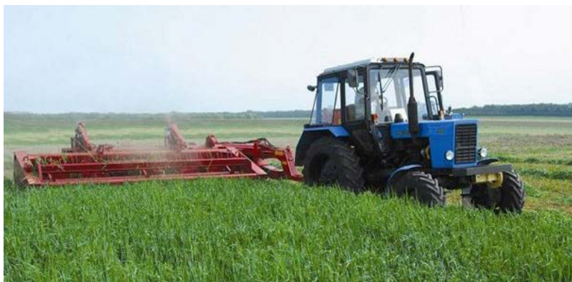
Рис. 1.18. Косилка-плющилка прицепная КПП-4,2 «ПАЛЕССЕ СТ42»
