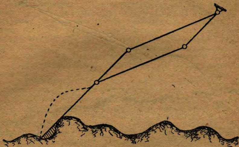
Рис. 5. Пример недоступных зон профиля для прямолинейного профилоприемника.
