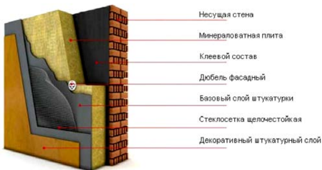
Рис. 15. Конструкция наружной стены с оштукатуренным фасадом
