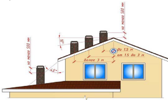
Рис. 21. Расположение трубы над уровнем кровли
