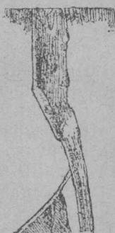
Рис. 22. Неправильно произведенный сръзь шипа.
