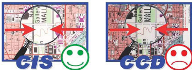
Рис. 7.78. Изображение в местах стыковки соседних CCD-камер
