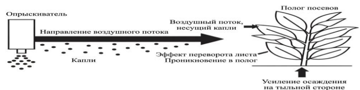
Рис. Схематическая диаграмма механизма технологии нанесения пестицидов на поверхности листьев и стеблей воздушно-капельными потоками
