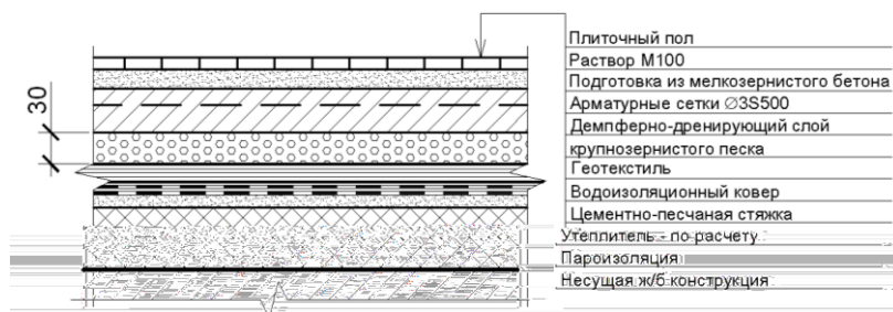
Рис. 9.8. Эксплуатируемая под пешеходные нагрузки кровля с плиточным полом со стяжкой по утеплителю
