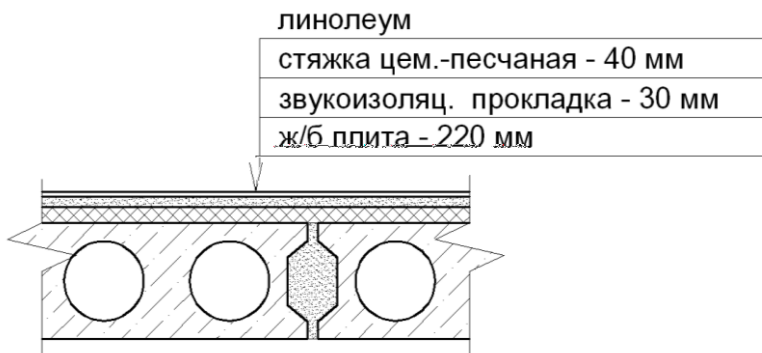
Рис. 7.10. Перекрытие с конструкцией пола из рулонных материалов
