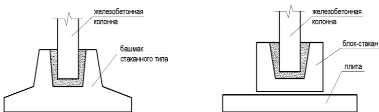
Рис. 4.7. Сборный столбчатый фундамент под колонну
