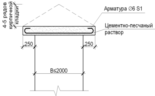
Рис. 5.7. Рядовая перемычка
