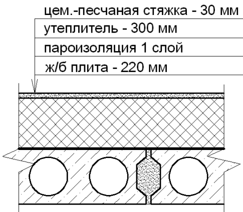
Рис. 7.12. Чердачное перекрытие в здании с холодным чердаком
