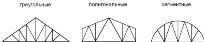
Рис. 7.13. Геометрические схемы ферм
