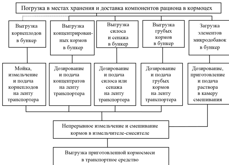
Рис. 2.1. Примерная технологическая схема кормоцеха
