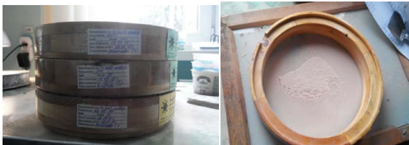
Рис. 3.9. Общий вид сит для определения дисперсности бленды
