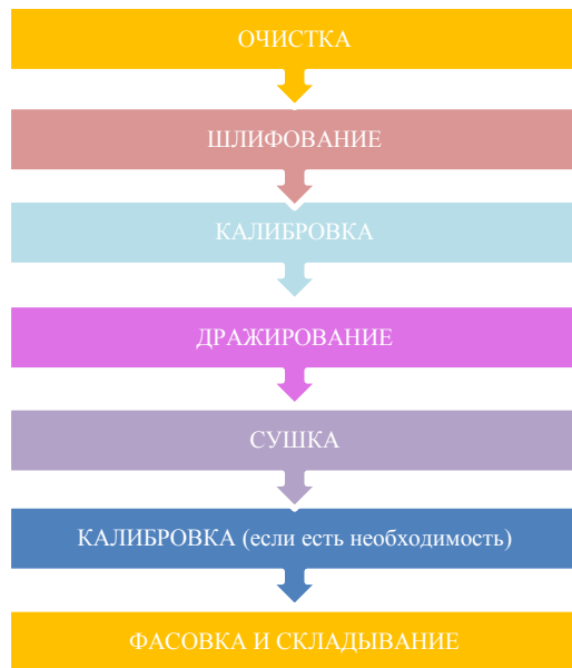
Рис. 1.8. Этапы производства дражированных семян сахарной свеклы
