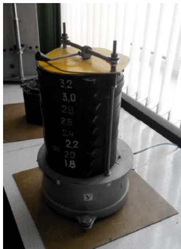
Рис. 3.4. Общий вид вибрационного решетного классификатора РКФ-1
