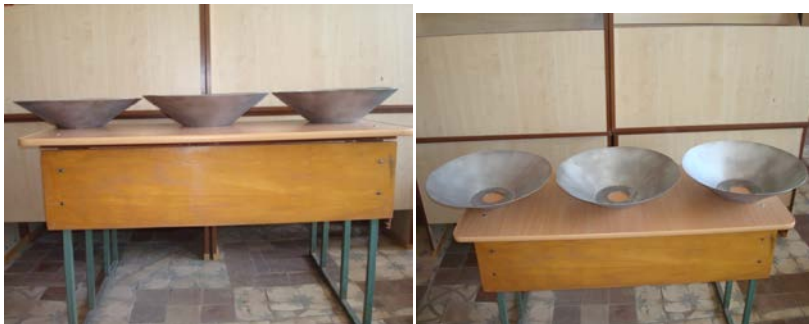
Рис. 3.15. Общий вид доньев дражироватора
