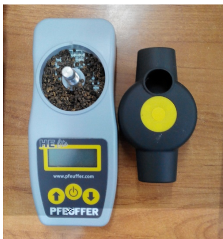
Рис. 3.3. Общий вид электронного влагомера Pfeuffer-hi lite
