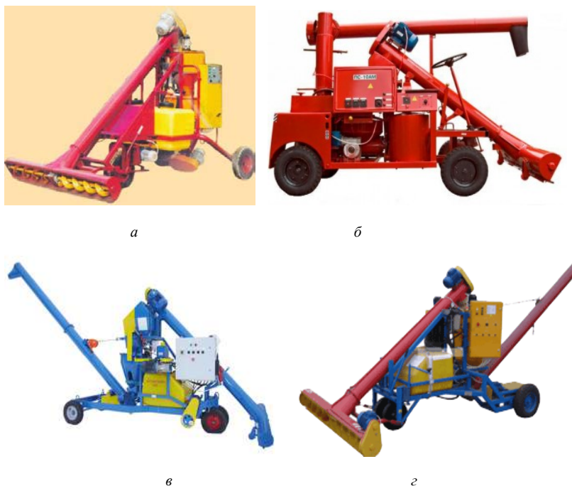
Рис. 1.4. Протравливатели семян: а – ПСШ-5; б – ПС-10АМ; в – ПС-20; г – Mобitох-super
