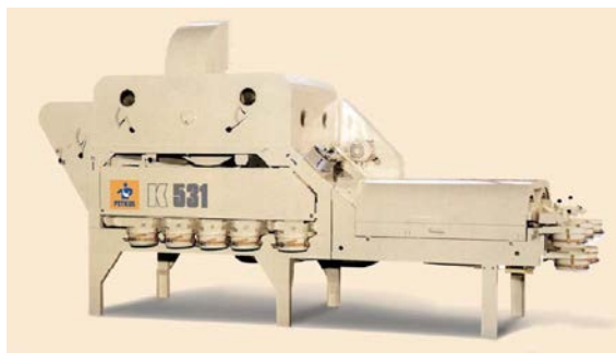
Рис. 1.2. Решетно-триерные машины: a – Petkus K 541; б – MC-4,5; в – Petkus K-531/1
