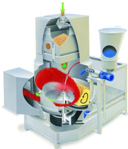
Рис. 1.19. Схемы машин порционного действия: a – Petkus СТ-50; б – Cimbria Centricoater
