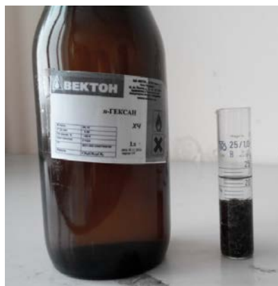
Рис. 3.7. Схема и общий вид мерного цилиндра для определения эквивалентного диаметра семени
