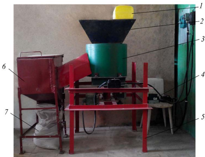
Рис. 3.11. Общий вид экспериментальной установки: 1 – резервуар жидких компонентов; 2 – бункер-дозатор сухих компонентов с отдельной камерой для семян; 3 – камера смешивания дражировщика; 4 – частотный преобразователь; 5 – рама; 6 – выгрузный бункер; 7 – мешок с обработанными семенами
