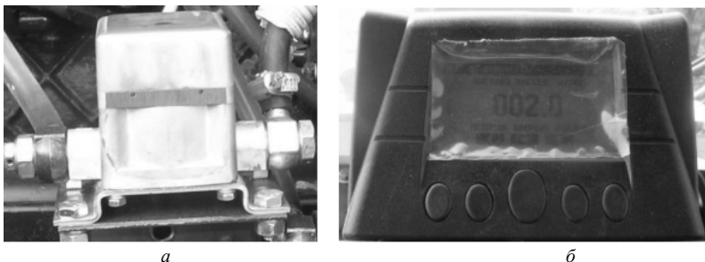
Рис. 3.10. Приборы для определения расхода топлива: а – расходомер ДРТ-5; б – терминал СКРТ 31
