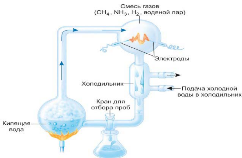
Рис. 7.1. Схема установки опыта С. Миллера и Г. Юри
