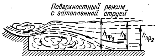
Рис. 4.7. Поверхностный режим сопряжения потоков в НБ сооружения
