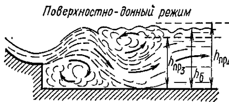
Рис. 4.8. Поверхностно-донный режим сопряжения потоков в НБ сооружения
