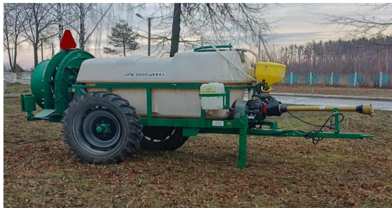
Рис. 1. Опрыскиватель диско-вентиляторный тракторный полуприцепной ОПВ-2000 «Шквал»
