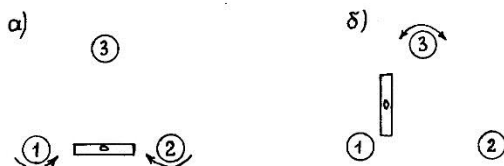
Рис. 2.11. Схема горизонтирования прибора
