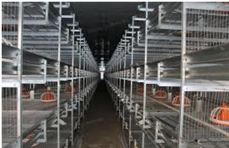
Р и с. 1. Оборудование для содержания бройлеров AviMax sliding, (Big Dutchman, Германия)
