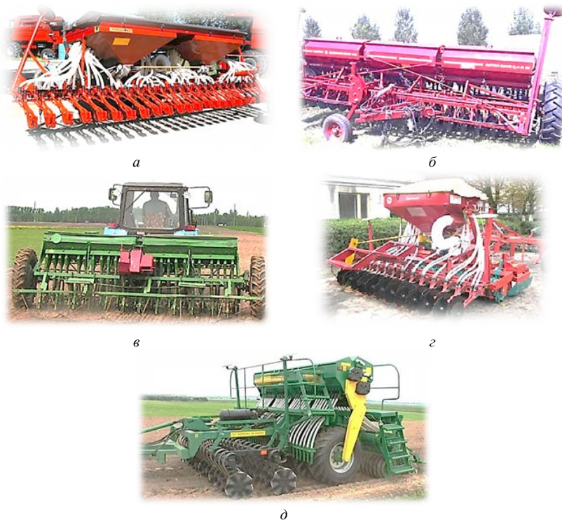
Рис. 1. Отечественные сеялки и агрегаты, применяемые для посева льна: а – сеялка СПУ-6Л; б – сеялка СЗ-5,4-02; в – комбинированная льняная сеялка СКЛ-3,6М; г – комбинированный посевной агрегат АПП-3А-02; д – комбинированный агрегат для посева льна АПЛ-4
