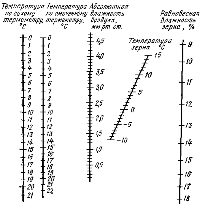
Рис. 2.3. Номограмма для определения возможности вентилирования зерна при отрицательных температурах
