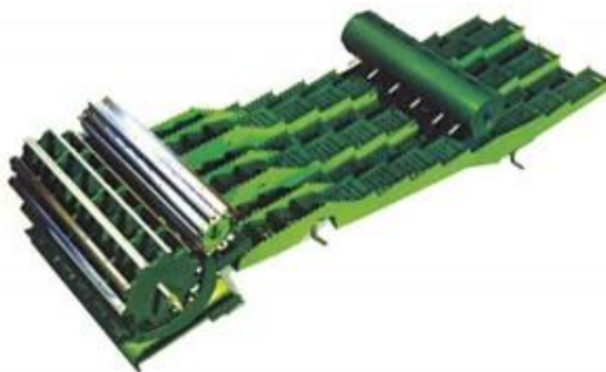
Рис. 6.4. Соломоотделители различных фирм: a – колесчато-пальцевой ворошитель фирмы CLAAS; б – роторный соломоотделитель фирмы CLAAS; в – роторный соломоотделитель фирмы JOHN DEERE
