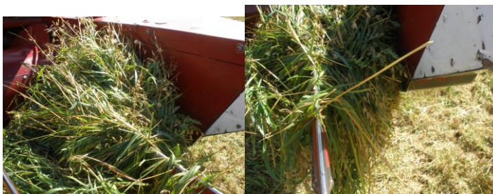
Рис. 4.7. Забивание убираемой массы на делителях у боковины жатки
