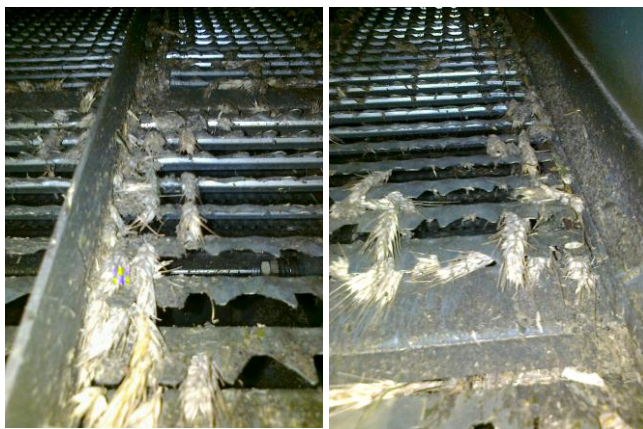
Рис. 6.6. Проблема забивания решет по краям разделительных полосок (особенно проявляется при уборке озимой ржи и тритикале)
