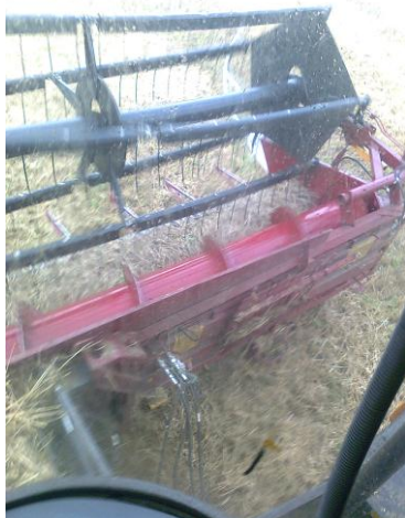
Рис. 4.8. Работа мотовила на коротком стеблестое
