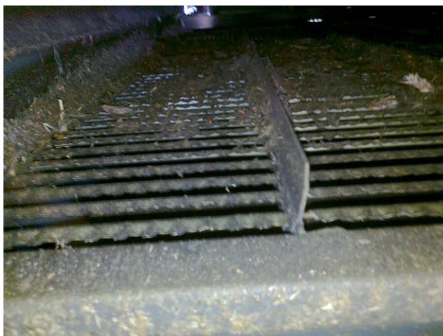
Рис. 6.7. Последствия неравномерного обдува решет очистки
