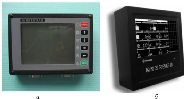
Рис. 7.3. Блок контроля и индикации технологического режима работы комбайнов: а – «БКИ-03»; б – «ВулКан-04»
