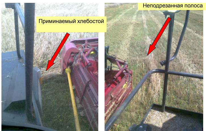
Рис. 4.5. Последствия некачественной работы делителей
