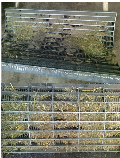
Рис. 5.3. Забивание внутренней и наружной поверхностей подбарабья продуктами обмолота и почвой
