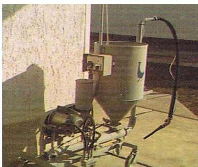
Рис. 41. Машина для принудительного откорма птицы
