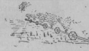
Рис. 168. Дождевальная труба на колесах
