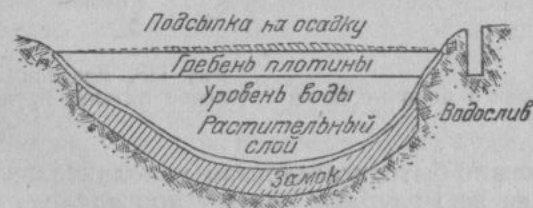
Рис. 114. Продольный профиль плотины
