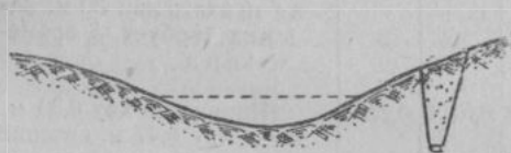
Рис. 103. Положение коллектора в понижении
