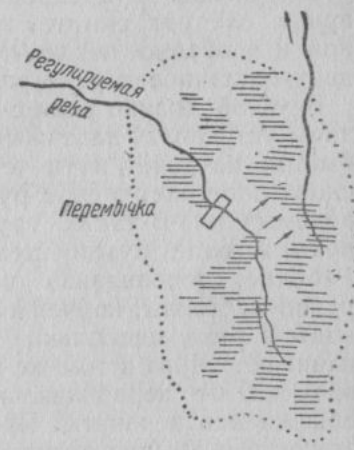
Рис. 83. Направление воды перемычкой в другую реку
