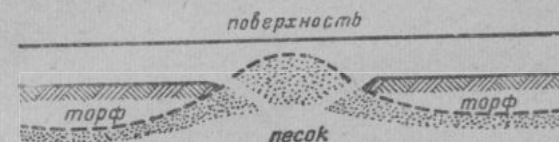
Рис. 58. Профиль дна пересечения каналом песчаного грунта
