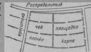
Рис. 162. Орошение затоплением чеками
