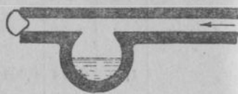
Рис. 104. Соединение осушителя с коллектором
