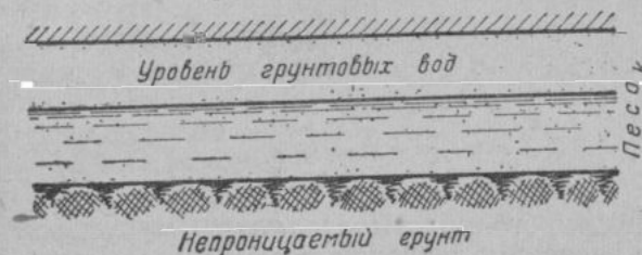
Рис. 38-а. Схема положения грунтовой воды: а — в песке; б — в суглинке (см. след. стр.)
