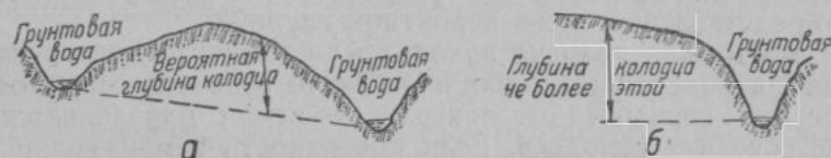
Рис. 135. Вероятная глубина до грунтовых вод при выходах их в балках: а—в двух балках с водой; б—в одной балке с водой
