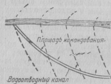
Рис. 154. Схема отвода воды из реки.
