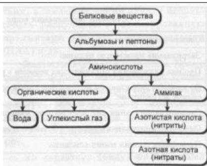
Рис. 1. Схема минерализации органических веществ в водоемах
