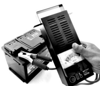
Рис. 7.6. Проверка аккумуляторной батареи анализатором состояния аккумуляторных батарей (нагрузочной вилкой)
