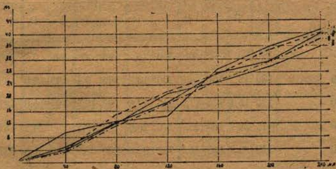
Рис. 10. Степень пружинности зубьев (деформация и нагрузка); к таблице № 1.
