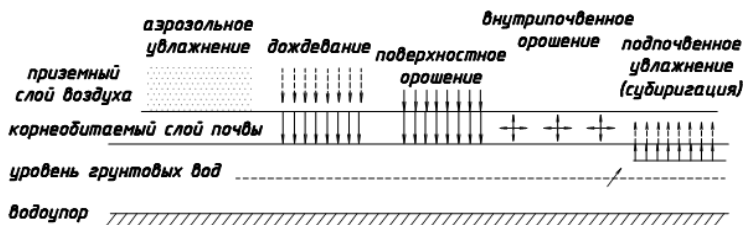
Рис. 4.1. Классификация способов орошения
