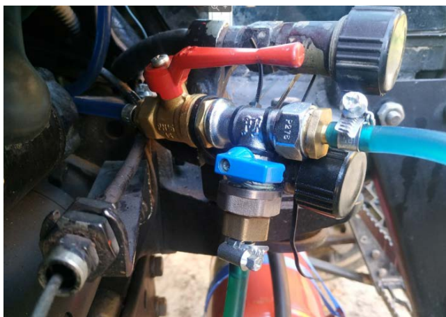
Рис. 1. Внешний вид топливной системы для приготовления и подачи многокомпонентного биотоплива: – дополнительный бак со встроенным рециркуляционным насосом; – тройник с кранами для регулировки подачи дизельного топлива и многокомпонентного топлива
