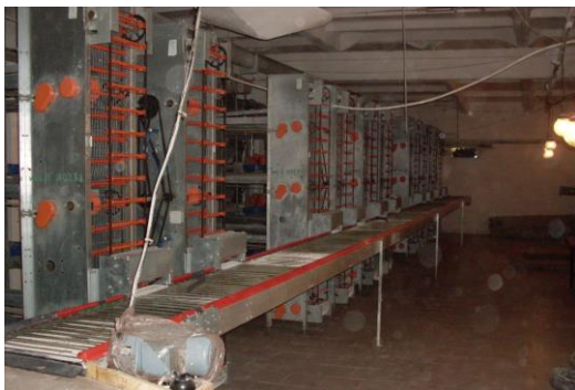
Р и с. 2. Клеточная батарея типа «Евровент»
