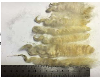
Рис. 25. Определение естественной длины шерсти
