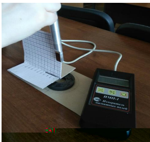
Рис. 2. Измерение магнитной индукции используемых магнитов с координатным устройством
