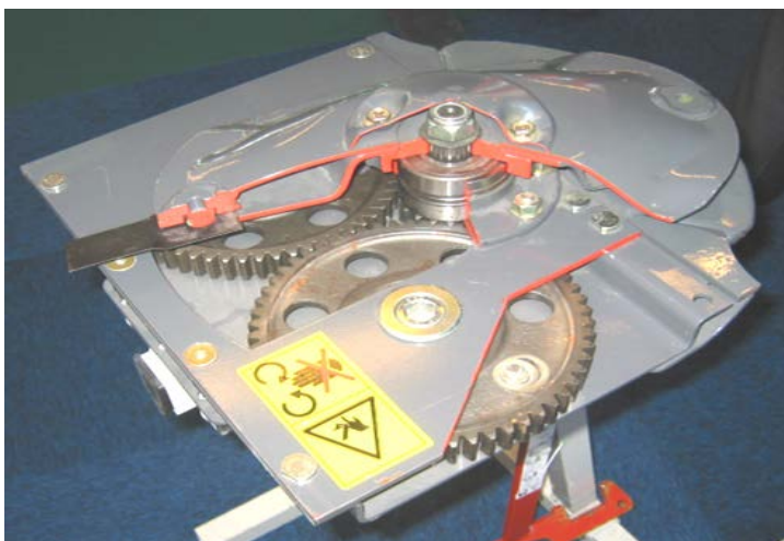
Рис. 2.32. Вид шестеренного привода роторов рабочего органа многороторной косилки
