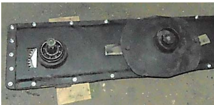
Рис. 5.4. Режущий аппарат многороторной косилки К-78М, оснащенный шестерней, в полости которой закреплена цилиндрическая вставка
