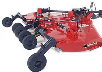
Рис. 2.60. Общий вид трехсекционных косилок: а – McConnell серии SR820; б – Bush Hog 2715L
