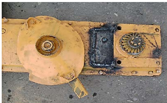
Рис. 2.93. Излом режущего бруса у первого ротора
