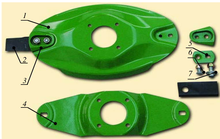
Рис. 2.33. Детали ротора косилок фирм Claas и Krone: 1 – диск; 2 – нож; 3 – накладка; 4 – пружинное днище; 5 – шайба; 6 – болт; 7 – палец
