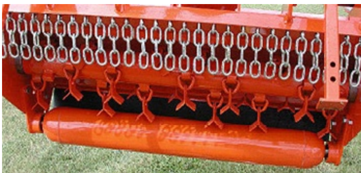
Рис. 2.49. Режущий аппарат косилки-измельчителя Phoenix SLE-48
