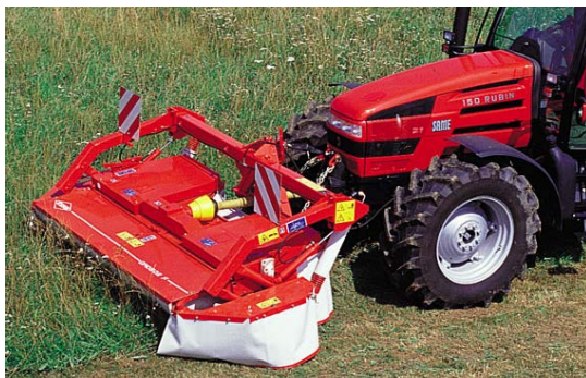
Рис. 2.14. Косилка с фронтально расположенным режущим аппаратом
