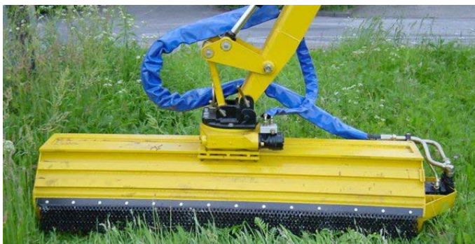
Рис. 2.54. Рабочий орган мелиоративной косилки-измельчителя Berky
