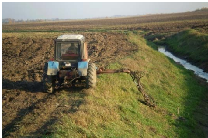
Рис. 1.6. Скашивание травы на откосе канала косилкой типа К-78М
