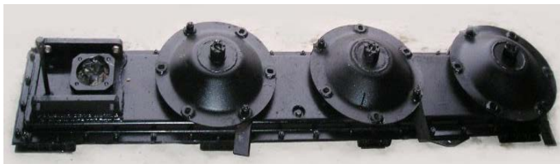
Рис. 2.19. Режущий аппарат роторной косилки КРД-1,5
