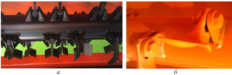
Рис. 2.50. Фрагменты барабанного аппарата косилки-измельчителя: а – вал с Y-образными ножами; б – крепление подрезающего молотка к валу
