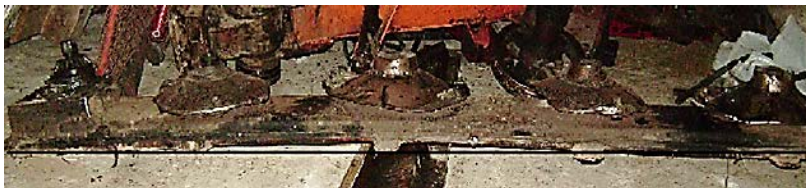
Рис. 2.91. Дугообразный изгиб бруса режущего аппарата
