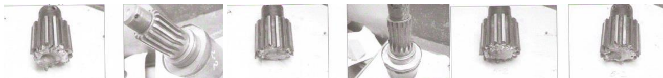
Рис. 6. Образцы разрушенных шлицевых концов
