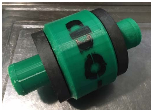
Рис. 1. Фильтр-омагничиватель воды ФО-2 (изготовлен на 3D Принтере Creatbot D600 Pro)
