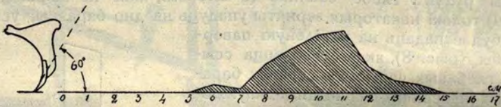
Рис. 9. Тангенсоїда: залежність паміж вишиною зерневого каналу і величиною кута \alpha .
